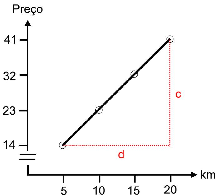
c  $\text{Inclinação} = \frac{c}{d} = \frac{(41-14)}{(20-5)} = \frac{27}{15} = 1.8$
